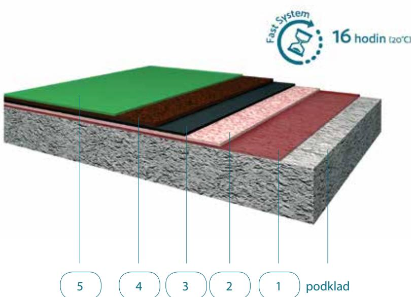
Vícevrstvý systém je způsob provedení podlah s vysokou mechanickou zátěží poskytující významné úspory pryskyřice. Používají se 100% pryskyřice nanášené stérkou a následně prosypané jemným křemičitým pískem (0,6 mm) mezi vrstvami. Tento typ podlahy je velmi vhodný pro použití v oblastech, kde je očekávána vysoká úroveň mechanické a chemické odolnosti s vylepšenými protiskluzovými vlastnostmi. Toušťka vrstvy systému je variabilní podle počtu vrstev (minimálně 3 mm).
