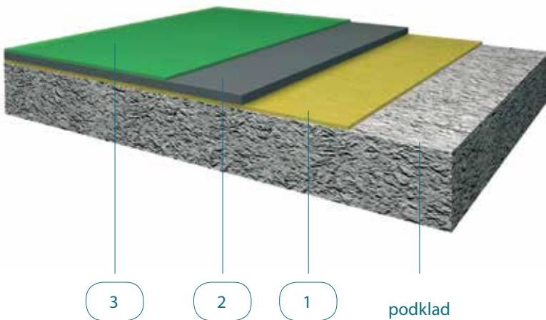
Epoxidová malta střední tloušťky, která po vyšetření poskytuje velmi silnou mechanickou odolnost a dekorativní vlastnosti. S klasickým vzhledem Terazza (pouze velké části). Přibližná tloušťka vrstvy: 10 mm.
